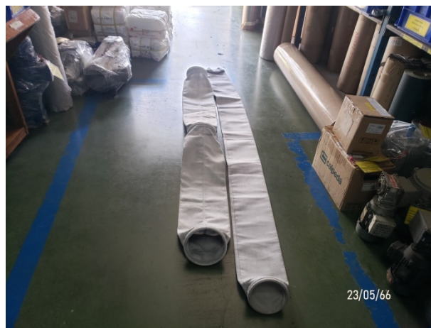
รูปที่ 3-11 ถังกรองสำรอง Dust collector
