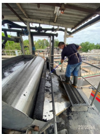
รูปที่ 3-3 การทำความสะอาด Bar Screen
